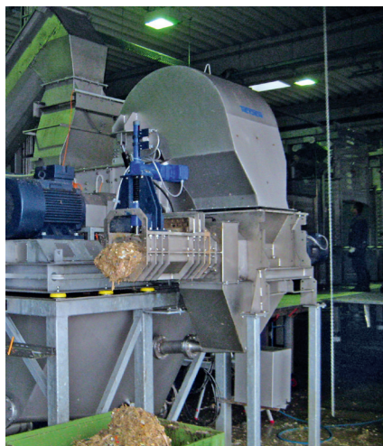
Presse à vis compactant les mat. indésirables
