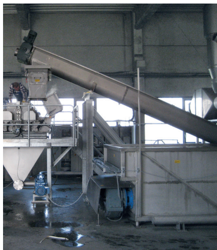
Vis doseuse et parc de stockage (fraction organique)
