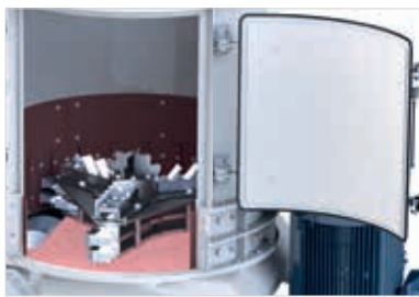
A Große Wartungstür für optimale Zugänglichkeit
