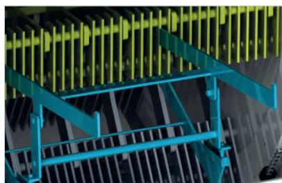
E Träger-Wechsellvorrichtung zum schnellen und einfachen Schlägerwechsel
