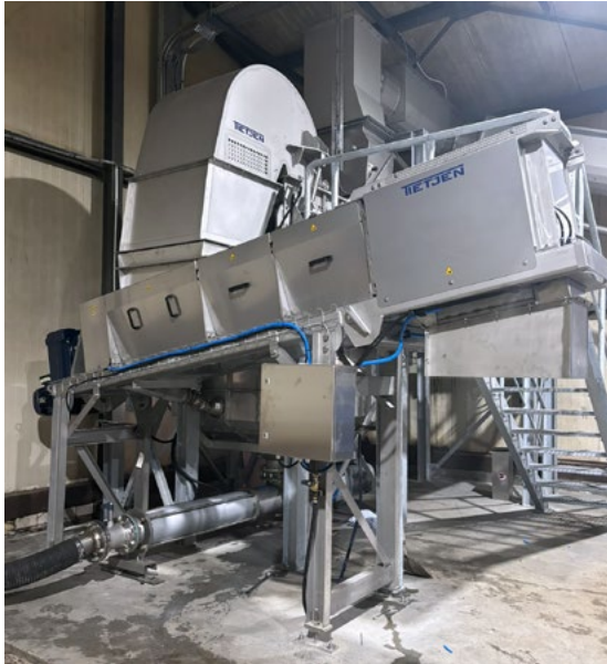
Déconditionneur DRM intégré dans une installation de valorisation de déchets
