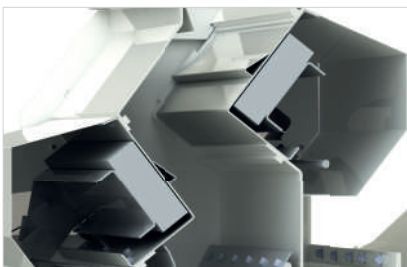
A Aimants pivotant à commande pneumatique pour leur nettoyage
