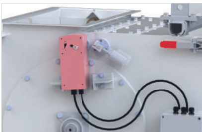
C Curseur de hauteur de couche à réglage électronique (en option)
