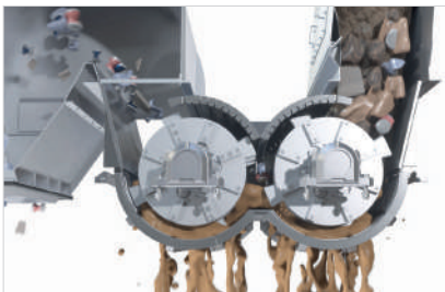
A Princípio de funcionamento DRM
