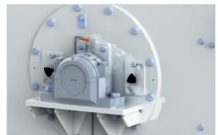
F Controle da temperatura dos rolamentos
