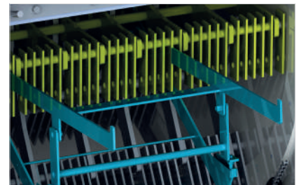
C Sistema de troca de bastidores para uma substituição rápida e fácil dos martelos
