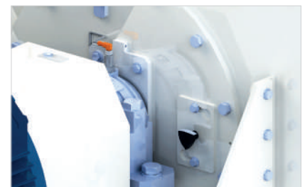
F Surveillance des températures de palier et de la chambre de broyage
