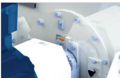
D Surveillance des températures de palier
