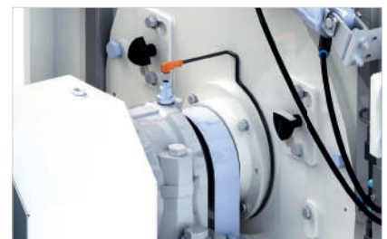
F Surveillance des températures de palier
