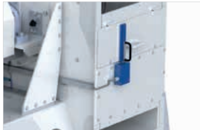
B Poche collectrice des corps étrangers avec trappe d'accès et verrouillage de sécurité
