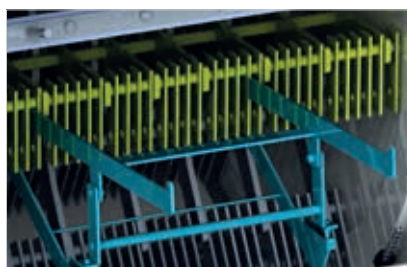
E Système à châssis porte-marteaux pour un échange simple et rapide des marteaux
