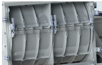
B Vedação especial da peneira e marco de suporte para a moagem fina
