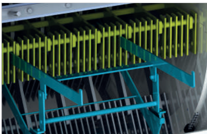
A Sistema de troca de bastidores para troca rápida e fácil dos martelos
